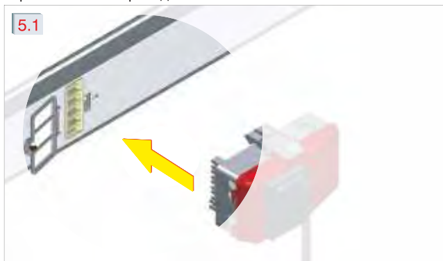
Контакты коробки вставляются в область расположения розетки окна, после предварительной центровки.
