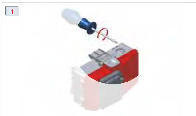
Открутите крепежные болты крышки
